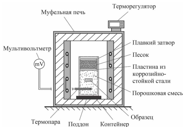
Рис. 1. Схема упаковки тигля со стальным образцом.
